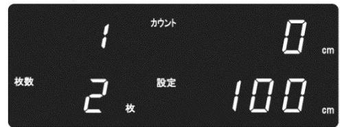
・ を押して、これから糊付を行うプログラム No.を表示させます。表示させた時点で、機械は糊付待機状態となっています。
