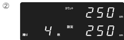
② 設定長さの手前で減速を開始し、設定長さに達すると自動的に停止します。
