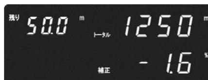
④ クロス残量を確認する場合は、[i] キーを押します。補助表示部にクロス残量がメートル単位で表示されます。
