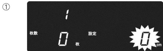
プログラムモードの画面で **[5]** を押すと、データ入力画面になり、設定長さ表示部が点滅して設定長さの入力を促します。
