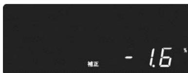
② [↑]、[↓] キーを押して補正率を設定します。補正率は-2.0%~2.0%まで、0.2%単位で設定できます。
