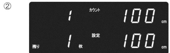
を押すと糊付を開始します。設定値に到達すると機械は停止し、設定枚数表示が 1 枚減って “残り 1 枚” となります。
