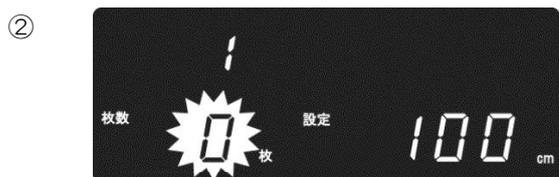
長さを入力します。**[1]****[0]****[0]** と押すと表示部が“設定 100cm”の点滅表示になり、**[2]** を押すと表示が点灯に変わり確定します。同時に枚数表示部が点滅し、入力待ちになります。
