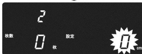
枚数を入力します。**[2]** **[2]** と押すと表示が“設定 2枚”の点滅表示が点灯表示に変わり、データが確定します。確定後、プログラムNo.表示は“2”に変わり、プログラム No.2の設定長さ入力待ちになります。
