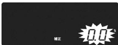
① [i] + [5] を押すと補正率入力モードに入り、パネルに"補正"の文字が点灯して現在の補正率が点滅し、入力を促します。(工場出荷時は"0.0")
