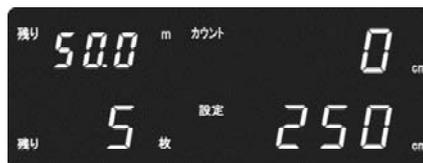
50ページの手順に従って、「残量表示」を「CLoS」に設定すれば、補助表示部に、クロス残量が常時表示されるようになります。
